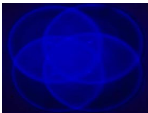
Рисунок 4. Изображение оптической освещенности на расстоянии 1 м от передатчика.
